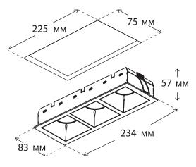
Подключение: 220 В Мощность потребления: 35.1 Вт Световой поток: 3900 Лм Угол света: 50° Цветовая температура: 3000 К Цветовая передача: 97 Ra Диммирование: да
